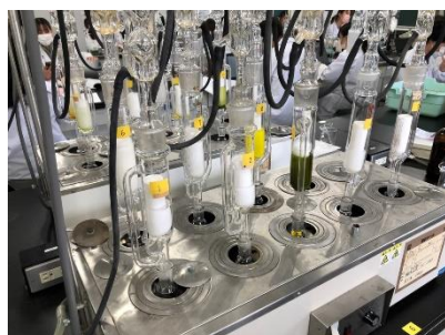
粗脂肪の定量に用いるソックスレー抽出器。食材によって様々な色の粗脂肪が抽出されている。
